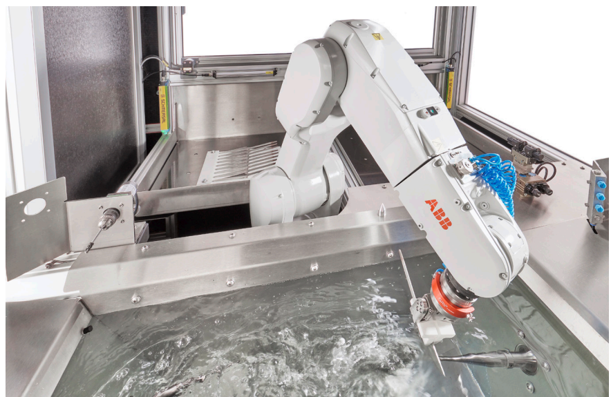
//////// Entgraten von unterschiedlichen Materialien prozesssicher, vollautomatisiert und punktuell
